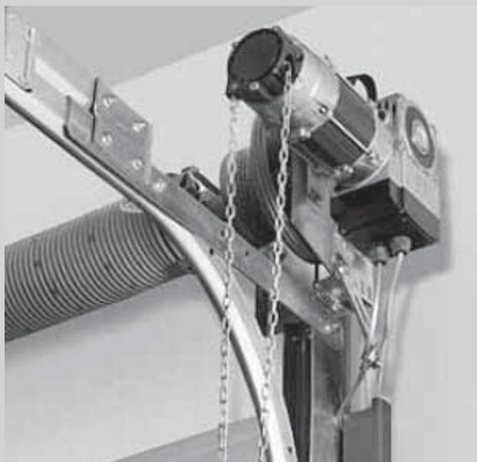
I motori della linea GIGAsedo sono stati sviluppati per portoni nei quali è richiesta facilità di operare, potenza e durabilità. Il modello 24.10x ha 100Nm di coppia motrice, il modello 18.14x ha 140Nm di coppia motrice.
